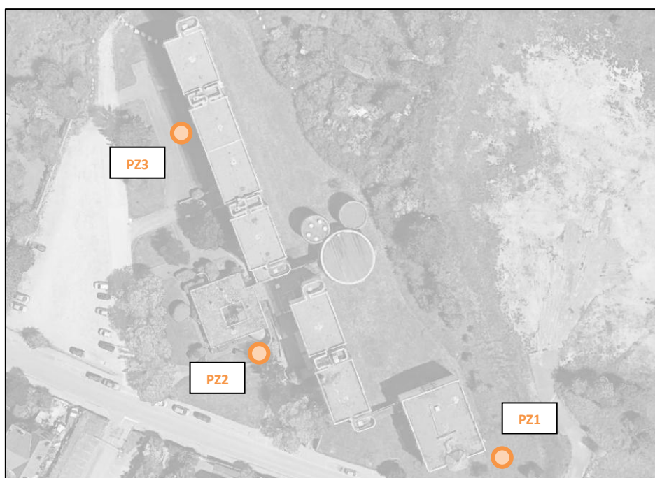
Implantation des piézomètres
